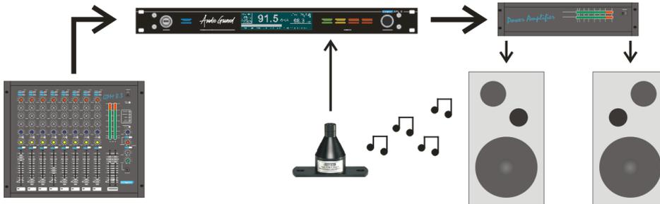
Illustration 1 : Raccordement du limiteur SPL6
