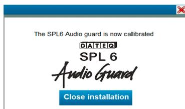
Le limiteur est maintenant paramétré. Contrôlez les paramètres en montant (légèrement) le volume de la table de mixage pour que le limiteur puisse s'activer. L'indicateur REDUCE du limiteur SPL6 s'allume alors et le niveau sonore est adapté automatiquement. Le cas échéant, les paramètres automatiques peuvent être rectifiés manuellement après coup via les onglets suivants.
